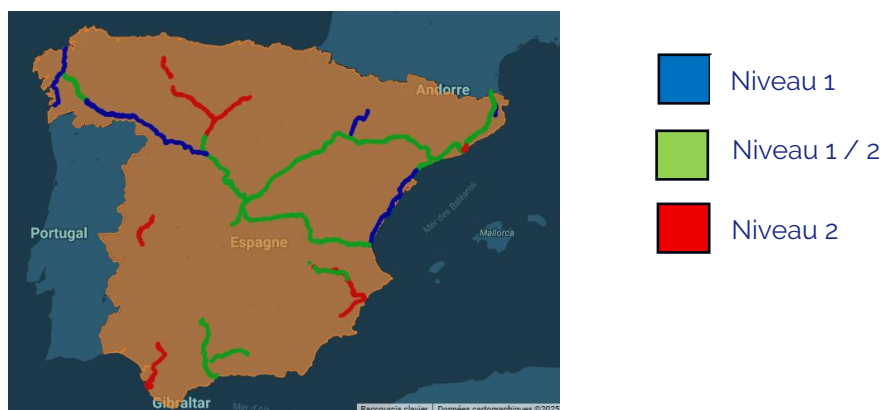
Figure 57 : Déploiement de l'ERTMS sur le réseau espagnol Source : ERTMS.NET, 2025
